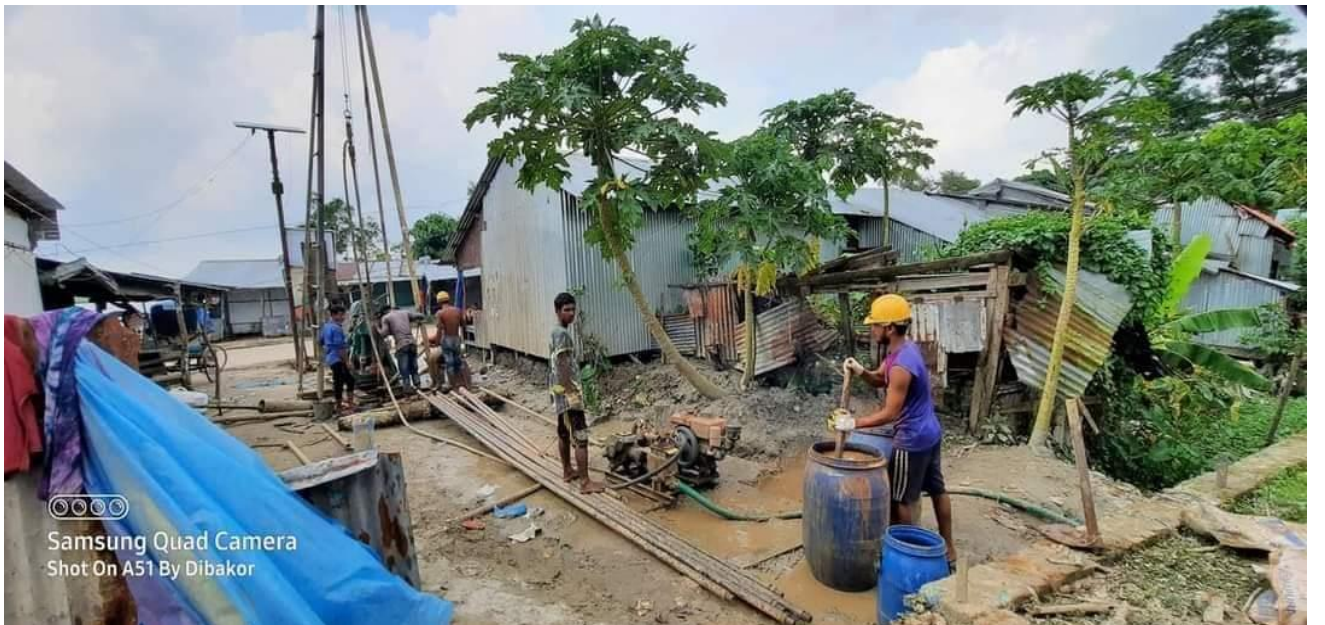
চিত্র-৪৪: কচুয়া-বেতাগী-পটুয়াখালী-লোহালিয়া-কালাইয়া সড়কে পায়রা নদীর উপর সেতু নির্মাণ প্রকল্পের মাটি পরীক্ষা কার্যক্রম
